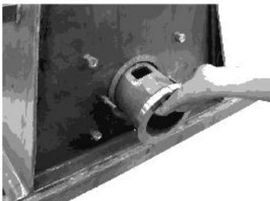
Inserire il dosatore precedentemente assemblato nel foro della casa turbina
