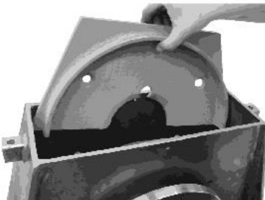
Una volta inserita la girante inserire le corazze trapezoidali superiori nella cassa turbina
